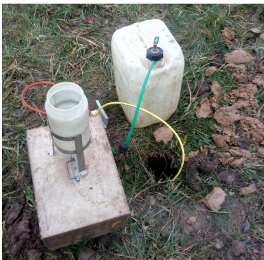
Figure 2.1 : Exemple d'essai Porchet
